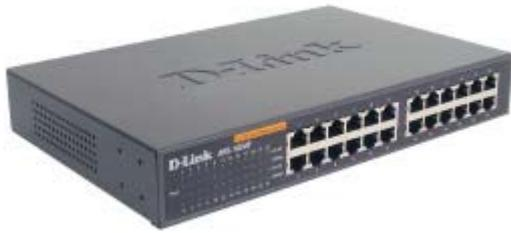
Diese Desktop-Switches sind auf den SoHo-Bereich und Arbeitsgruppen ausgelegt. Sie bieten 24 10/100Mbit-Anschlüsse für Arbeitsplatzrechner oder Server. Hubs können ebenfalls an die Switches angeschlossen werden. Alle Anschlüsse erkennen automatisch die Übertragungsrates (10Mbit oder 100Mbit) der angebotenen Geräte.
