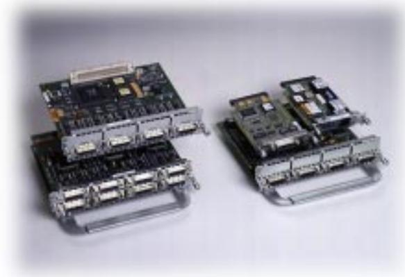
Das serielle NM-4T-Netzwerkmodul hat vier synchrone, serielle Schnittstellen. Das Netzwerkmodul unterstützt einen Gesamt-Vollduplex-Durchsatz von 8 Megabits pro Sekunde (Mbps), der über einen Port (mit 8 Mb/s) oder auf allen vier Ports (mit 2 Mb/s auf jedem Port) erreicht werden kann.
